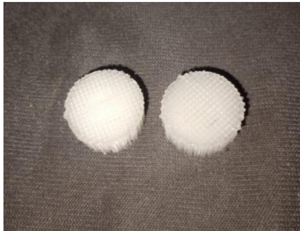
Figura 20. Scaffolds de PLA obtidos por manufatura aditiva
