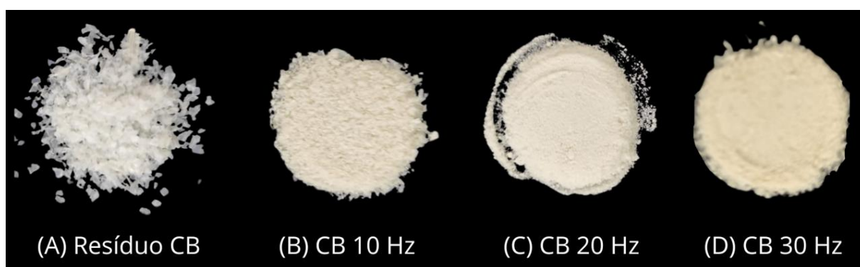
Figura 5. Resíduo (A) e micronizados de celulose bacteriana (CB) em 10 (B), 20 (C) e 30 (D) Hz.
