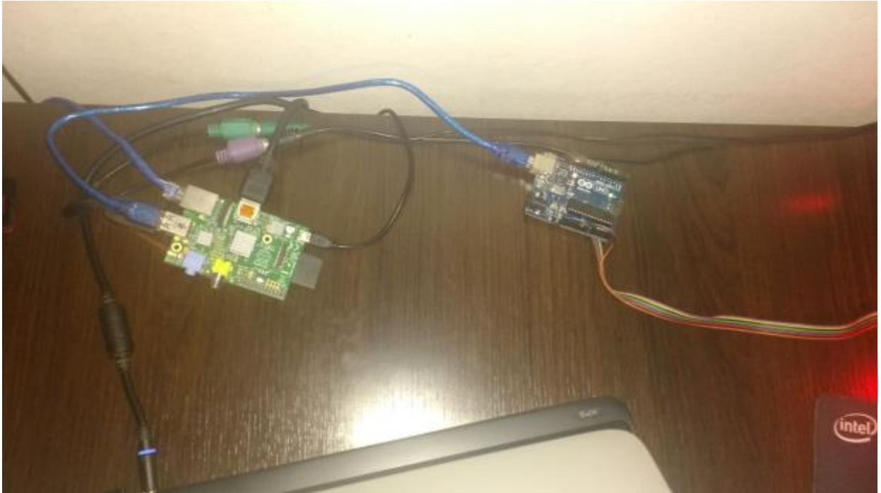
Figura 7 – Ponte entre Arduino e a Raspberry PI
